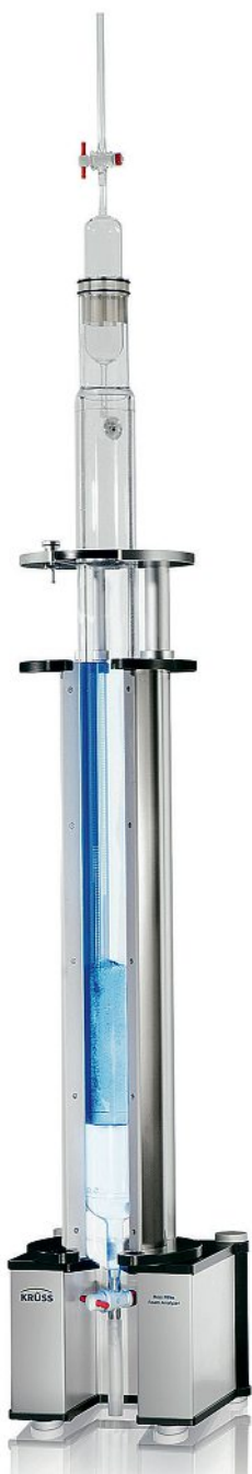
Der Ross Miles Foam Analyzer – RMFA von KRÜSS für elektronische Schäumbarkeitsmessungen nach ASTM D 1173
