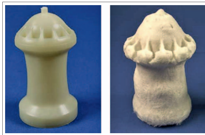
Bild 7. Verbleibende Langglasfaserstruktur nach dem Ausschmelzen der Polymermatrix.
